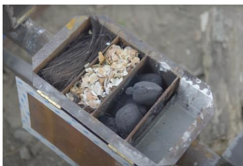
Gambar 3 : Box Filter dan Filter INSINERALIS
