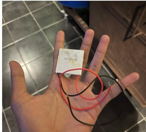
Gambar 4 : Spesifikasi Bentuk Peltier
